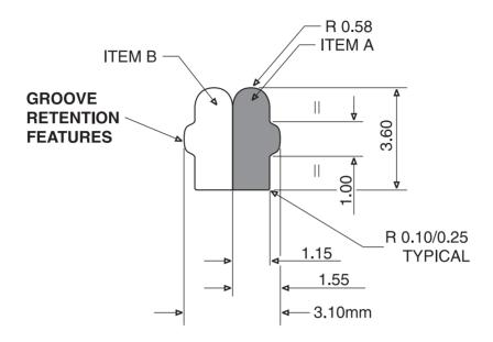
ITEM A : CONDUCTIVE R/F SEAL ITEM B : NON-CONDUCTIVE SEAL
